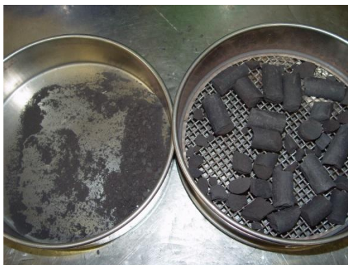
Рисунок 3 – Рассев брэксов (48 часов вылеживания) после 5-кратного сбрасывания с 2-х метровой высоты
