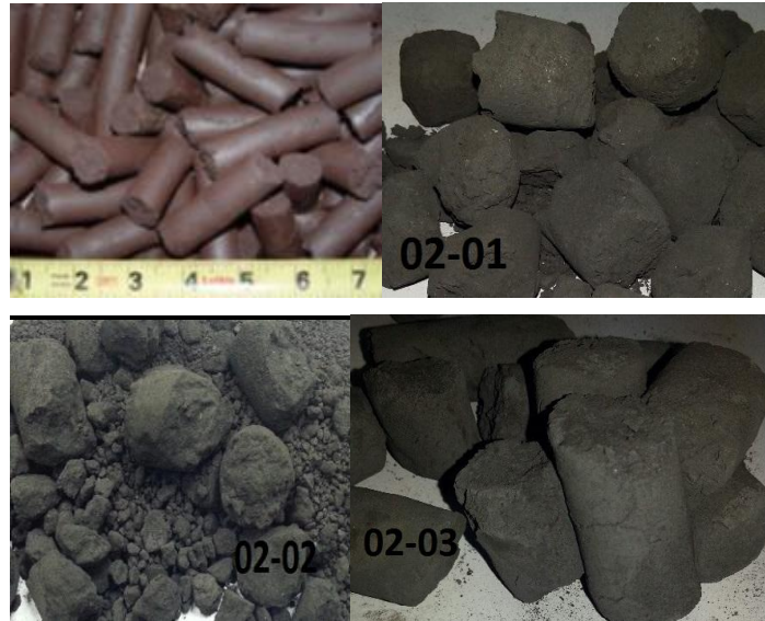
Рисунок 8 – Сырые (вверху слева) и восстановленные брэксы после извлечения из стальных пакетов
