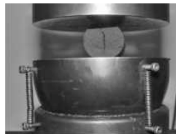
Рис. 1. Размещение опытного образца для оценки прочности брэкса на раскалывание
