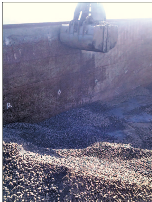
Рис. 6. Выгрузка из баржи. Перевалки (порядка 20): экструдер > конвейеры > самосвал > штабеля > фронтальный погрузчик > грузовик > штабель > фронтальный погрузчик > бункер > грейфер > баржа > грейфер > бункер > конвейеры > самосвал > штабель > фронтальный погрузчик > хранилища завода > печь
