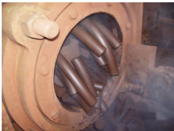
Рис. 1. Окускование мелочи латеритной никелевой руды экструдером Steele-90 в Колумбии
