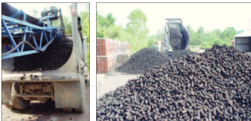
Рис. 4. Погрузка свежизготовленных брэксов на грузовик и выгрузка на склад, спустя 5 мин после изготовления
