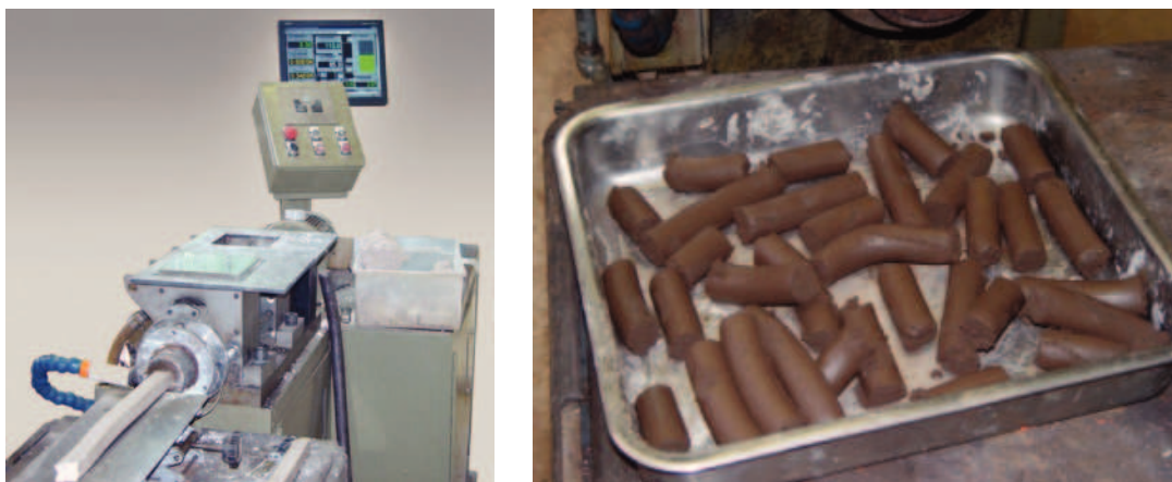
Рис. 1. Лабораторный экструдер J.C.Steele и образцы брэксов для выплавки ферросиликомарганца
