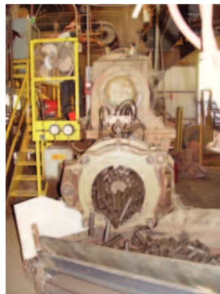
Рис. 3. Изготовление опытно-промышленной партии брэксов на экструдере Steele 75 (производительность 55 т/ч)
