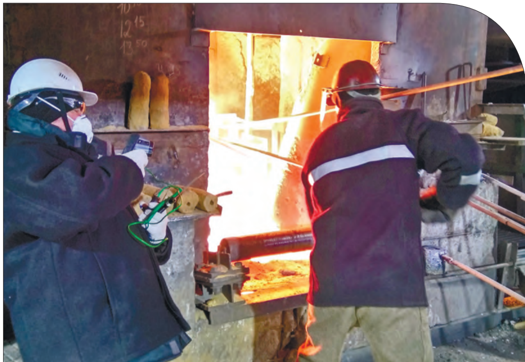
Представители компании «SmartProf» провели комплекс замеров температуры: окружающей среды, воздействия на человека теплового излучения на разном расстоянии от его источника, а также степень интенсивности конвективного и контактного тепла.
