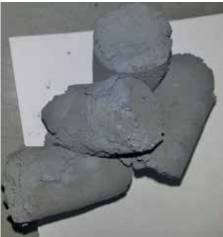
Рис. 5. Слипание брэксов 01-02 в процессе твердофазного восстановления
