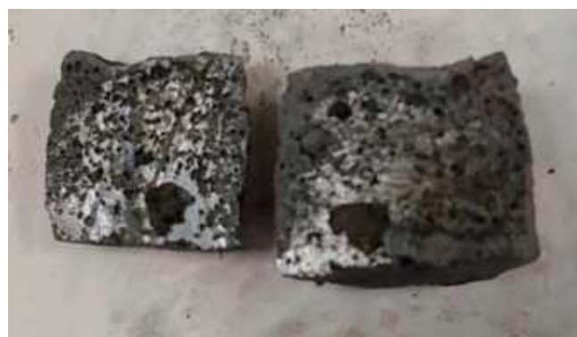
Рис. 2. Внешний вид брикетов после выдержки в муфельной печи при 1100 °С в течение 3 ч
