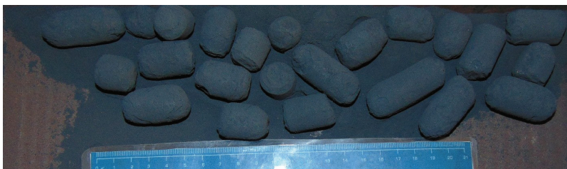
Рис. 6. Внешний вид пробы после испытания на низкотемпературное восстановление – измельчение (ISO 13930)
