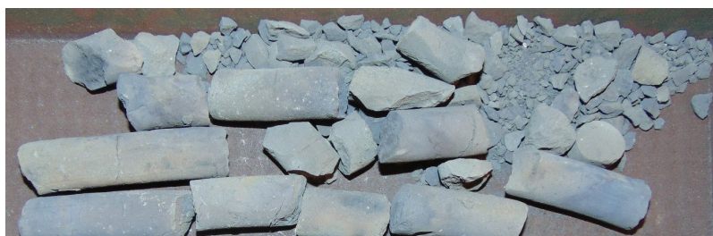
Рис. 4. Внешний вид пробы после измерения относительной восстановимости (ISO 7215)
