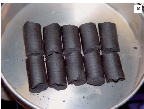
Р и с. 5. Исходные коксовые брэксы (а) и после испытаний на прочность при сбрасывании (б)
