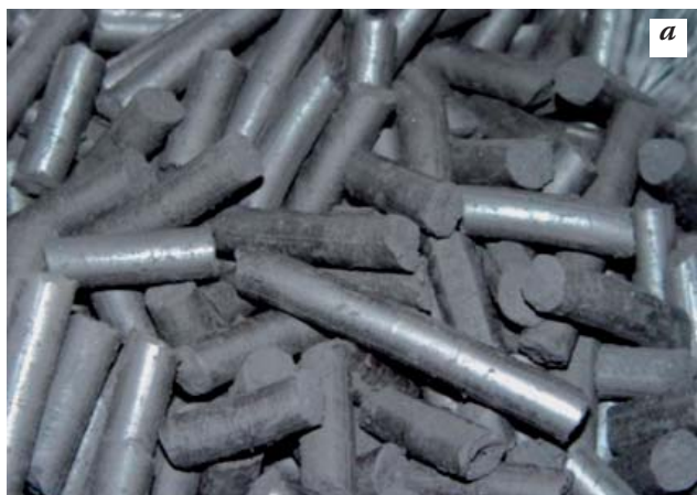
Р и с. 4. Коксовые брэксы до (а) и после (б) барабанных испытаний
