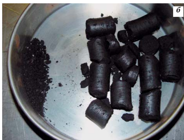
Р и с. 5. Исходные коксовые брэксы (а) и после испытаний на прочность при сбрасывании (б)
