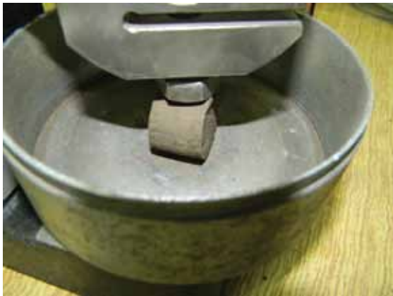
Рис. 1. Раздавливание цилиндрического (регулярного) брэкса
