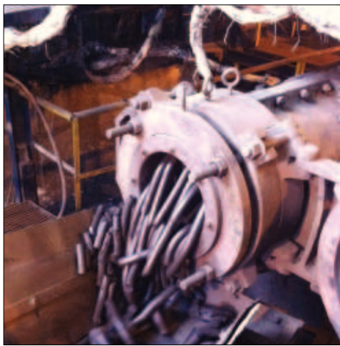
Рис. 1. Продукты экструзии на выходе из экструдера Steele 25 (а); брэксы в штабеле (б). Индия, Suraj PL, июль 2012
