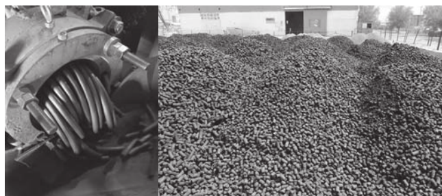
Рис. 2. Экструзионные брикеты на выходе из экструдера и при сушке на специальной площадке
